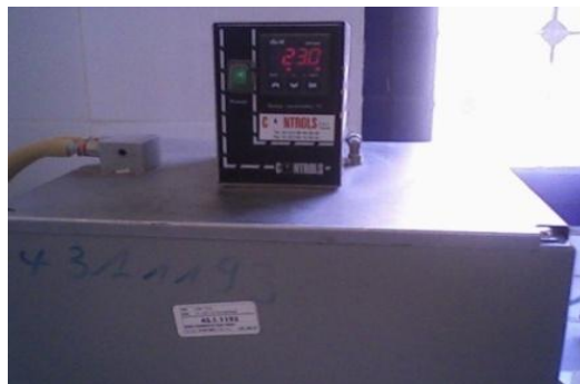
Figure V.1: Bain thermostatique pour maintenir les produits à la température de 25 °C
