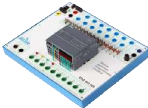
Figure 18 : Automate Programmable Industriel Didactisé API Siemens [17].
