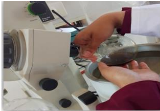
Figure 29: Évaporation des filtrats dans un rotavapeur (Photo personnelle 2024).
