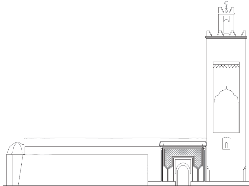
Figure 4.15 : Façade principale de la mosquée El-Atiq,(échelle : 1/200). Source : Auteur, 2015.
