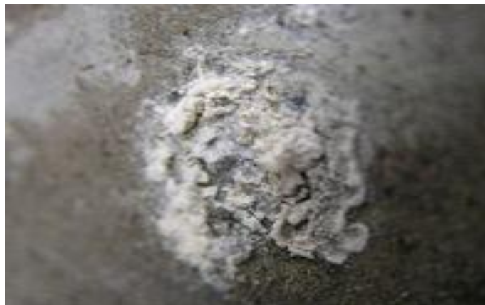
Figure. III.4. Piqûre en gros plan — la pustule d'hydroxyde d'aluminium est bien visible
