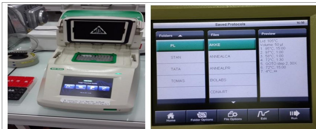
Figure 10 : Thermocycleur et le programme PCR pour l'amplification du gène ADNr16s
