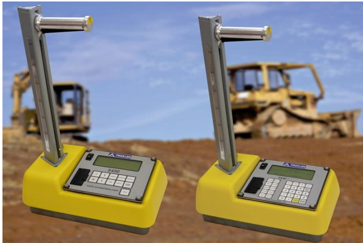
Figure n°43 : L'appareil de compacité (nucléo-densimètre).
