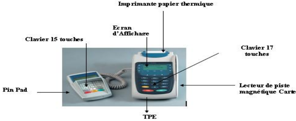
الشكل رقم 3-6: رسم تخطيطي لجهاز الTPE: 1
