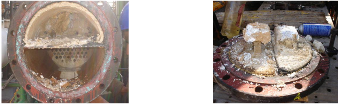
Figure 8 : Les tartres formées sur la boîte de distribution
