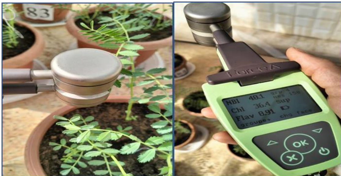
Figure 18: Mesure optique des pigments foliaires (chlorophylle, flavonoïdes) et du Nitrogen Balance Index (NBI) chez le pois chiche à l'aide du capteur portable Dualex®.
