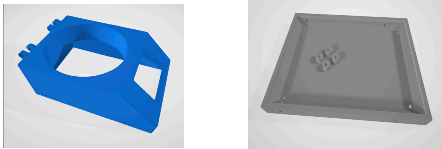
Figure 2.15 — Modélisation 3D du boîtier (Tinkercad ) — Support mécanique du moteur brushless
