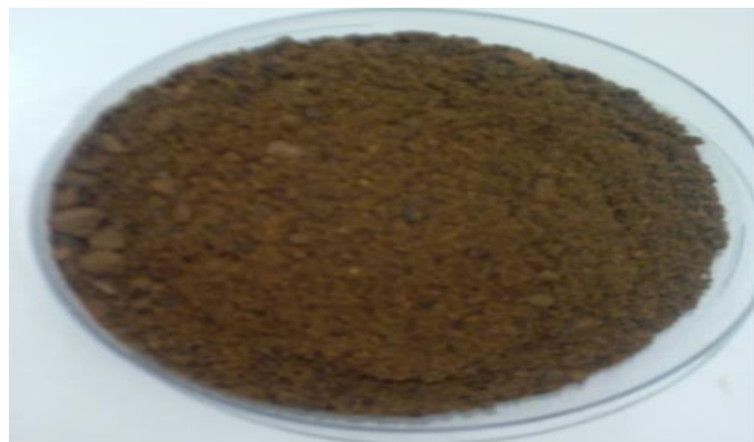
Figure 12 : sol pollué par les hydrocarbures.
