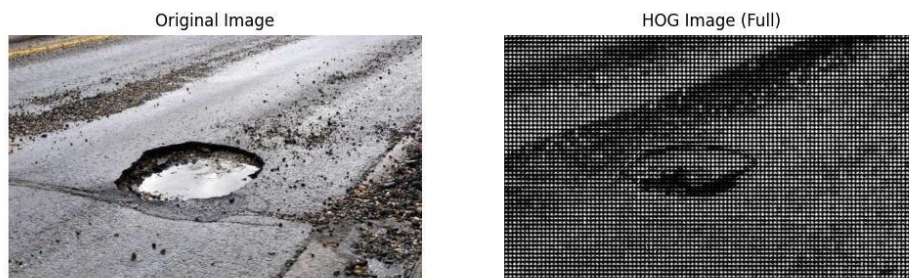
Figure 3.4 . Exemple d'application du HOG sur une image présentant un nid de poule
