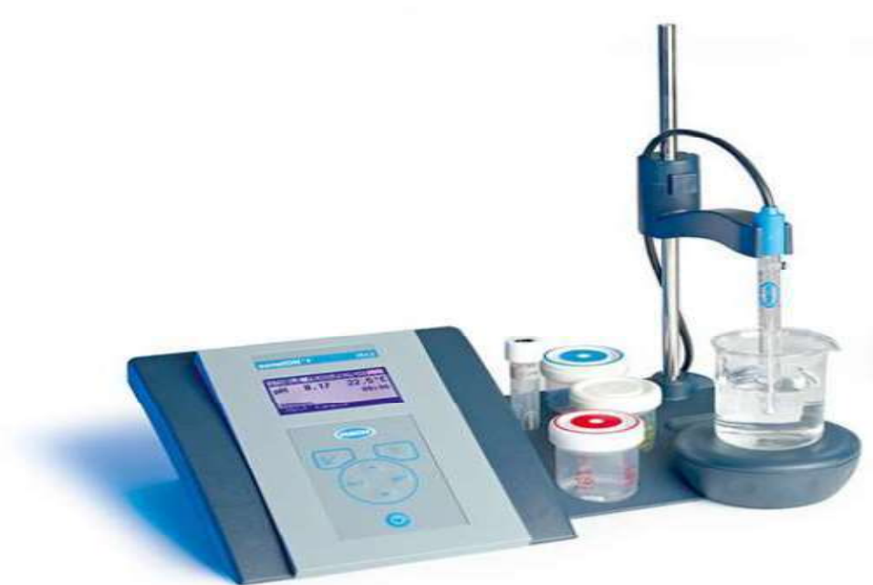
Figure 12: mesure de la conductivité électrique (Source : biolab.fr)
