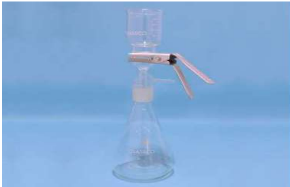
Figure 14: Système Filtration des MES (Source : auxilab.es)
