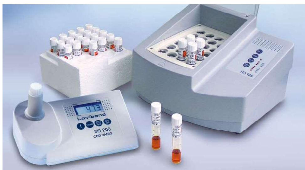
Figure 16: Analyse de la DCO (Source : assistec.ma)
