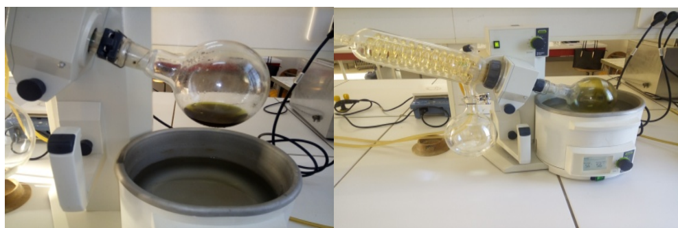
Figure 38 : Extraction par macération et séparation par rotavapor
