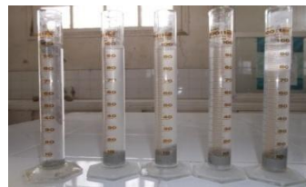
Versés en petites fractions avec la spatule, dans l'eau distillée contenue dans le tube en verre gradué (de 100 ml)
