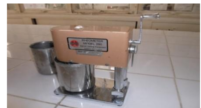
Mesure viscosité de la bentonite (L600 et L300)
