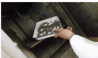
Mettre la suspension de bentonite en étuve ( 110\text{c}^\circ )
