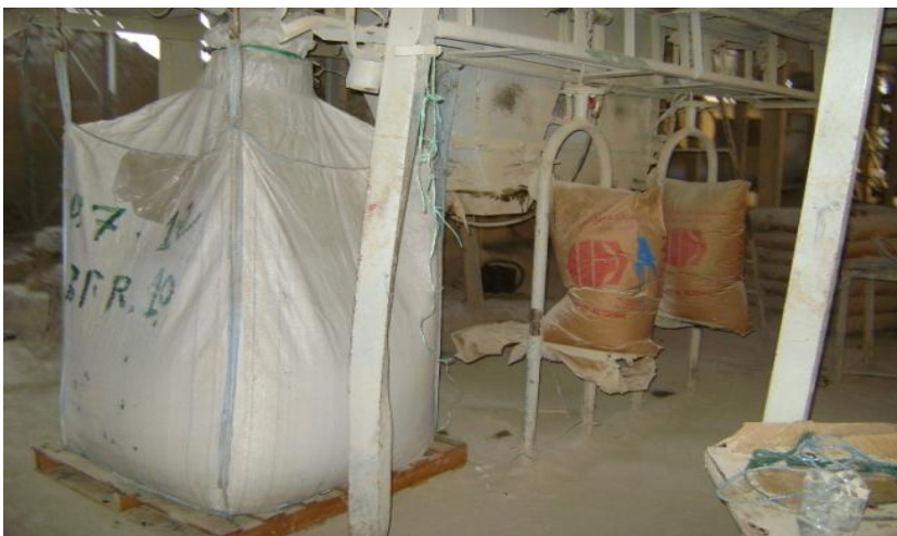
Figure N° 10 : Ensachage en sacs ou en Big Bags.
