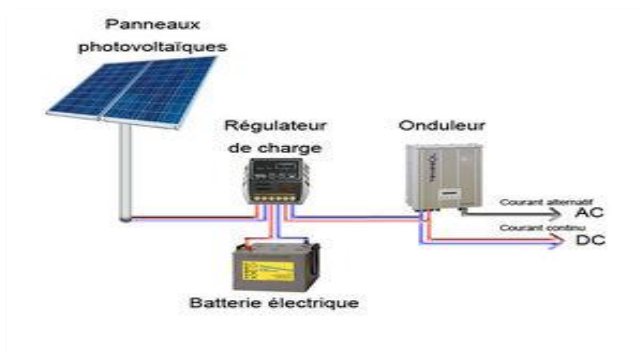
Figure 2.25 : Schéma d'un système autonome.
