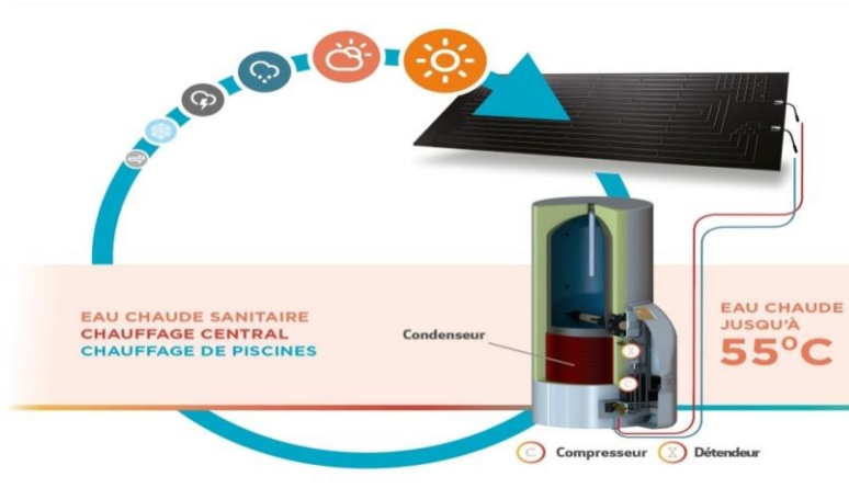
Figure 1.8 : système solaire thermodynamique.
