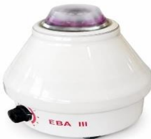
Figure III.4 : Centrifugeuse utilisée pour la séparation solide/liquide
