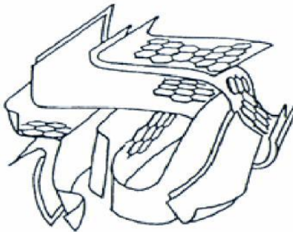
Figure II.2 : Représentation schématique de la microstructure du charbon actif [30].
