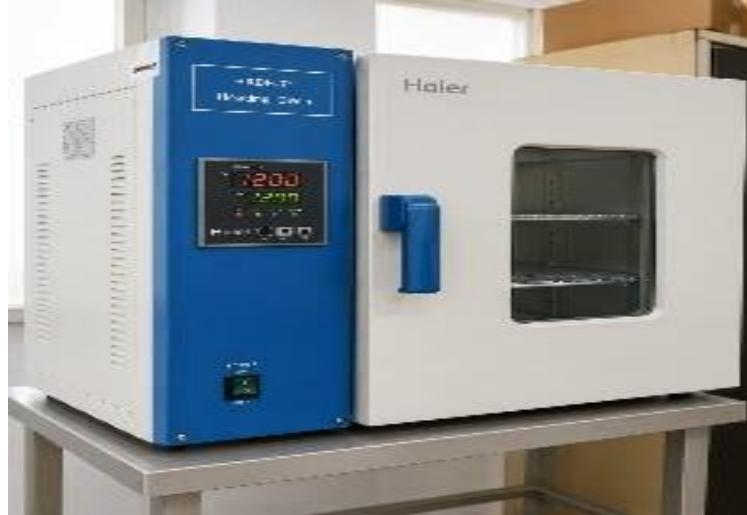
Figure III.5 : Étuve utilisée pour le séchage des adsorbants
