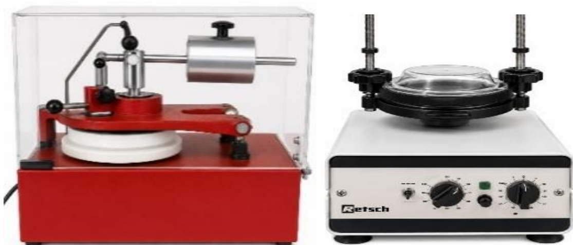
Figure III.6 : Broyeur et tamis utilisés pour la préparation des adsorbants
