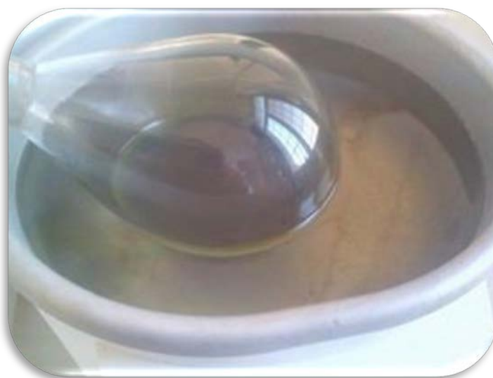
Figure 16: Evaporation de l'extrait par un évaporateur rotatif. ( Original, 2016 )
