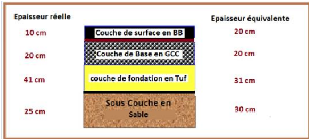
Figure IV.4.4 : schéma des différentes couches
