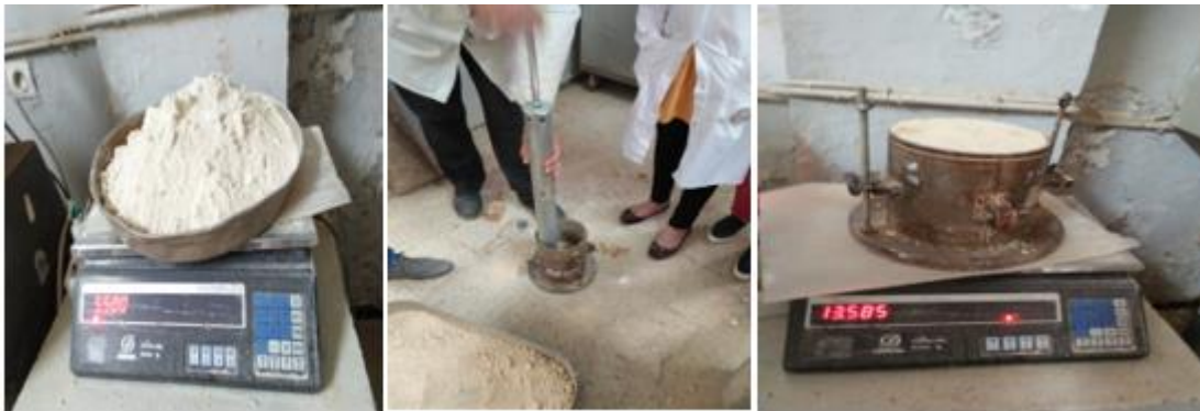
Figure I.5.17 : les étapes de l'essai Proctor
