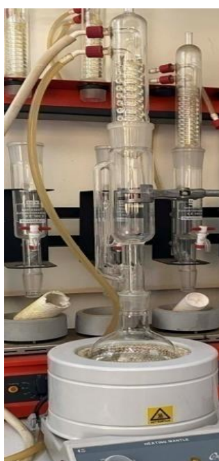
Figure46 :Extraction par le dispositif de Soxhlet (Original , 2026).
