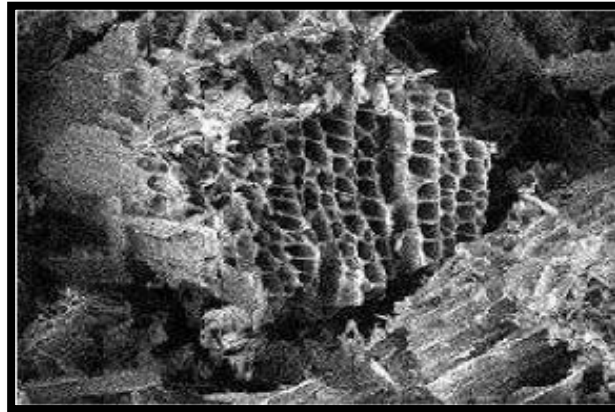
Figure I.1 : Structure du charbon actif vu sous un microscope électronique [2].
