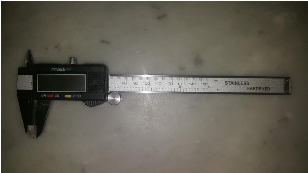
Figure 04 : Pied a coulisse électronique 150mm
