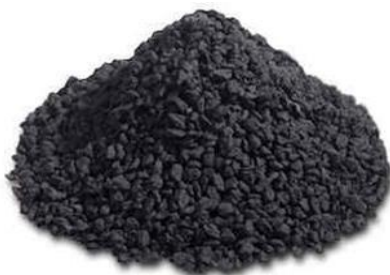
Figure I.3 : Charbon actif en grain
