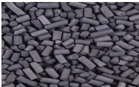
Figure I.1 : Charbon actif extrudé
