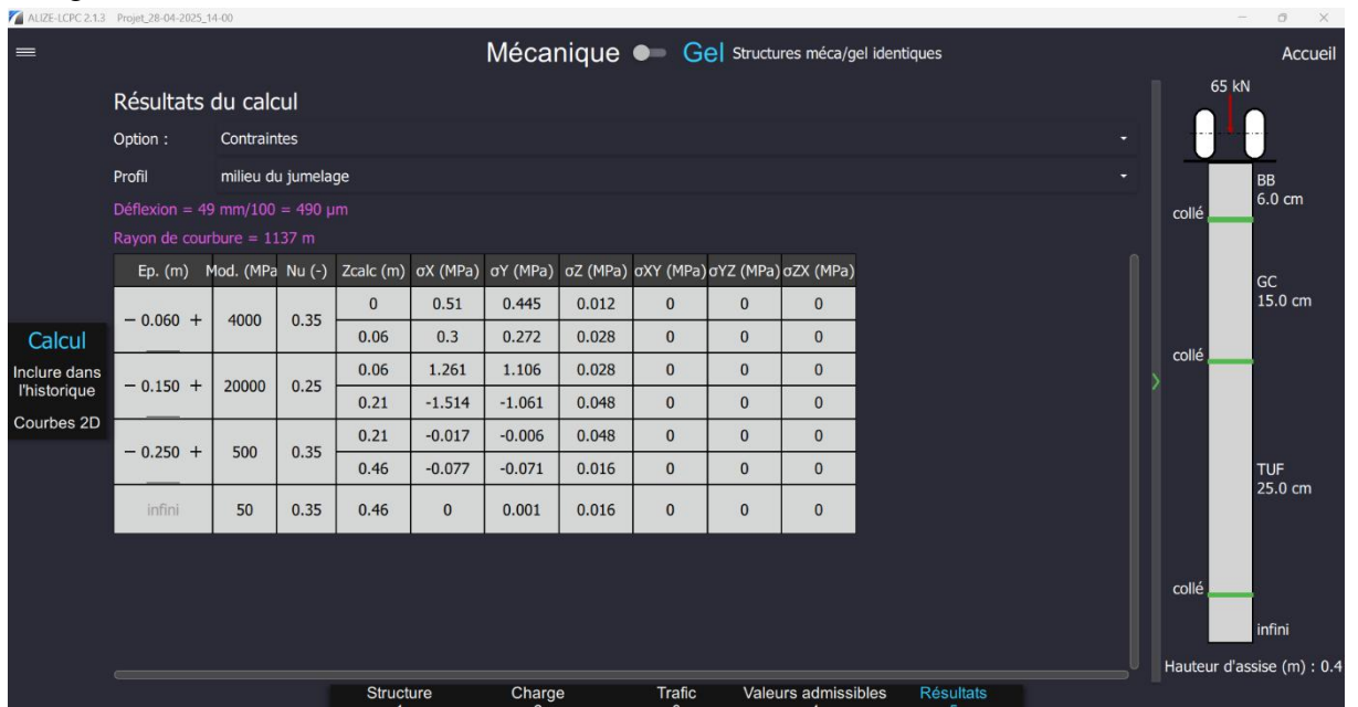
Figure V.4 : résultat mécaniques simulés par Alize-structure 3
