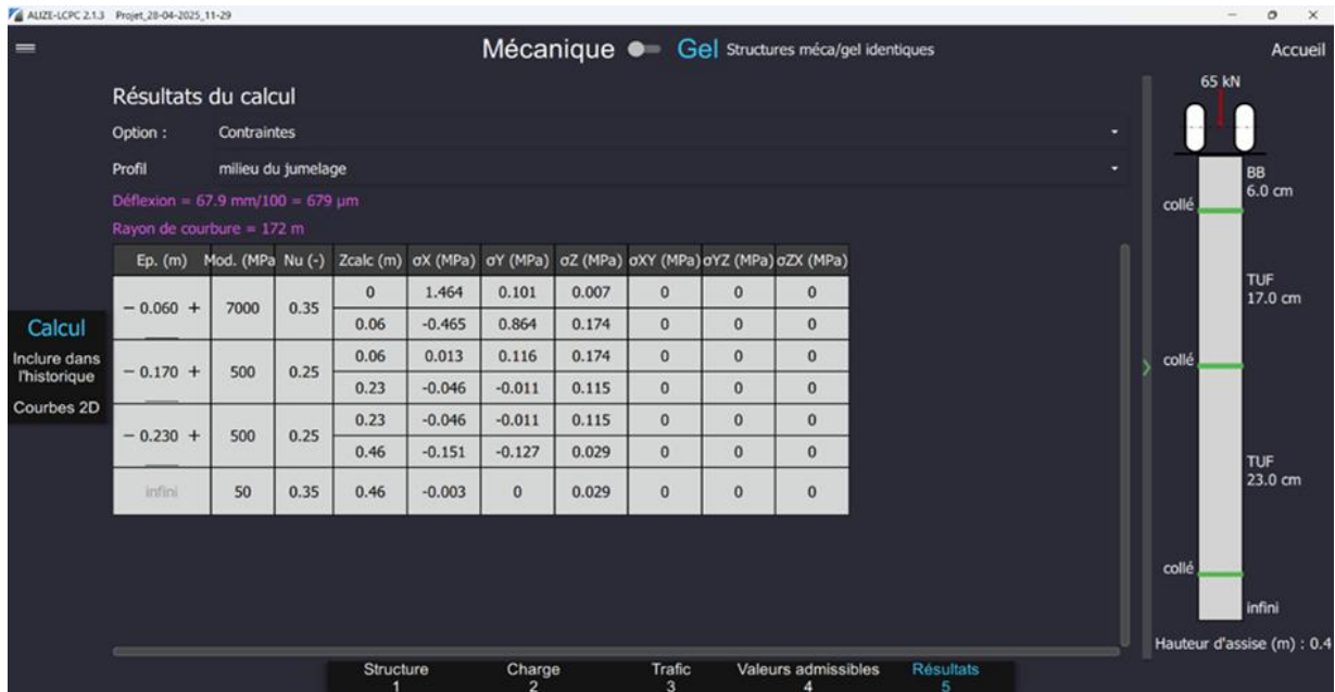
Figure V.3 : résultat mécaniques simulés par Alize-structure 2
