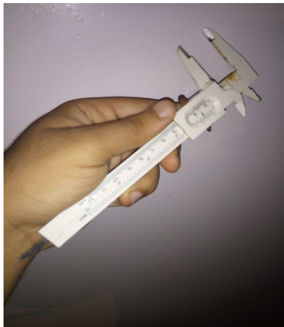
Figure 33 : Pied à coulisse utilisé. (Photos prises par Benbachir, 2017).
