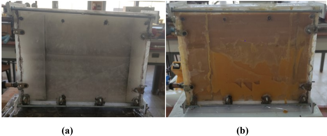
Figure 3.5 : Remplissages de MCP : a) Paraffine, b) Cire d'abeille.
