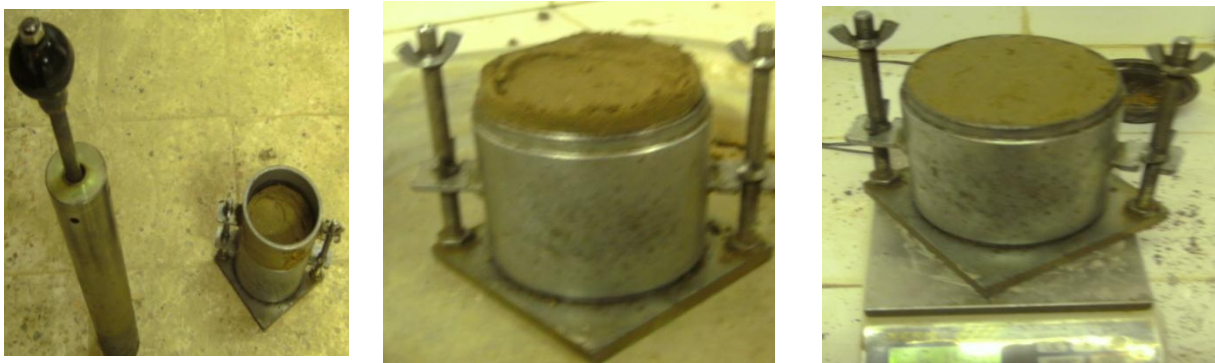
Figure III.9 : l'essai de Proctor
