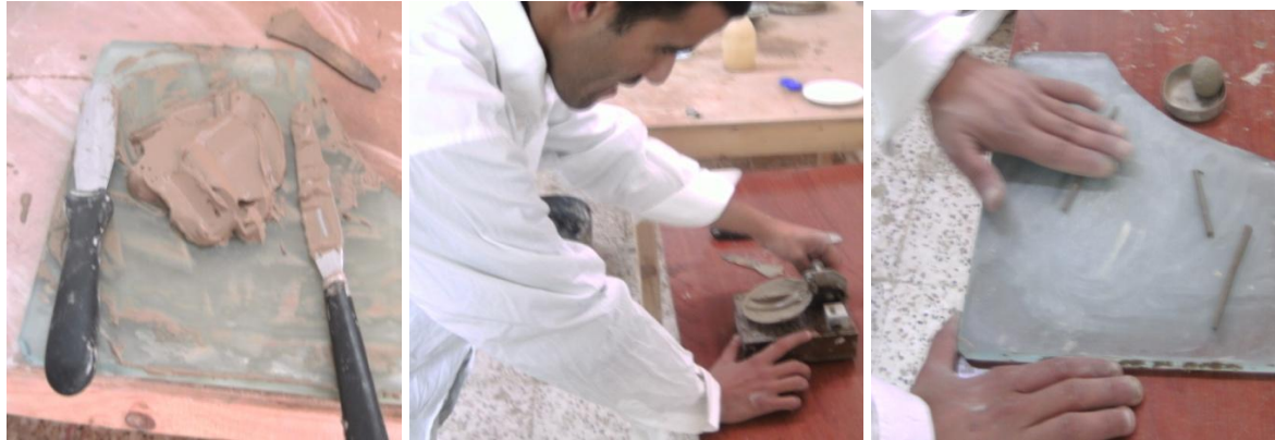
Figure III.7 : l'essai des limites d'Atterberg
