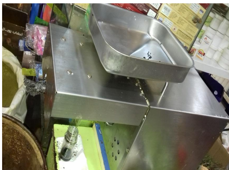
Figure 8 : l'extracteur de l'huile fixe par pression mécanique à partir des graines.
