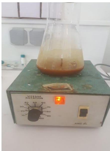
Figure n°6 : agitation de la phase organique avec le \text{MgSO}_4 (Original)
