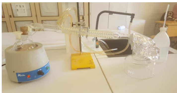
Figure n°7 : hydrodistillateur pour l'élimination d'eau (Original)
