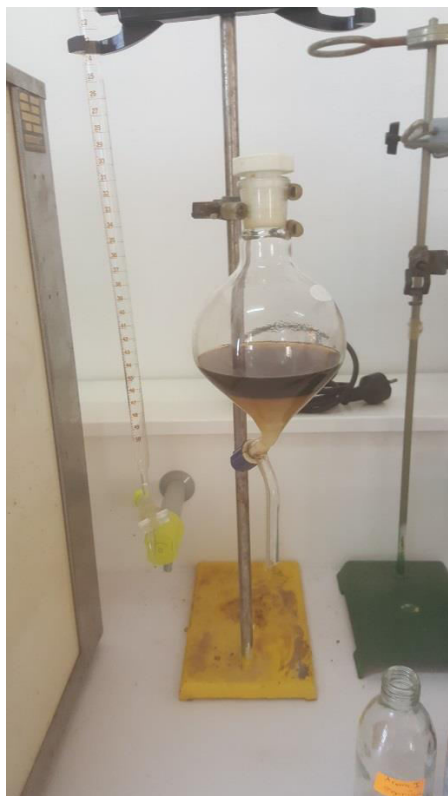
Figure n°5 : séparation des phases dans une ampoule à décanter ( Originel )
