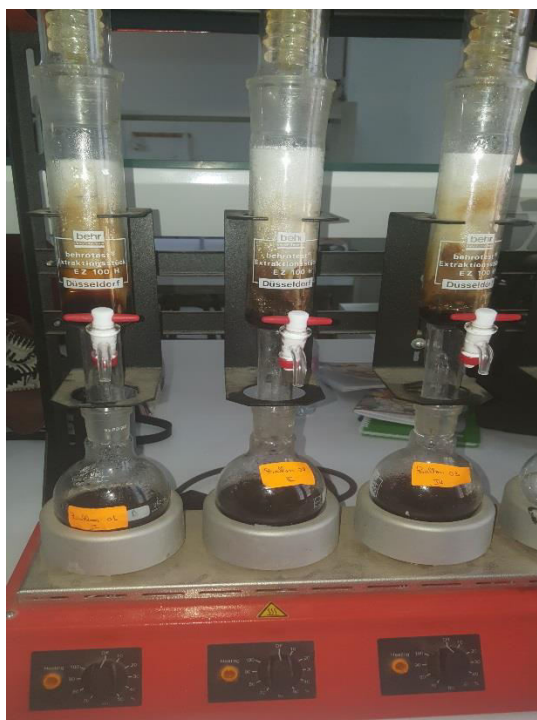
Figure n°4 : placement des échantillons dans l'appareil de soxhlet ( Original )
