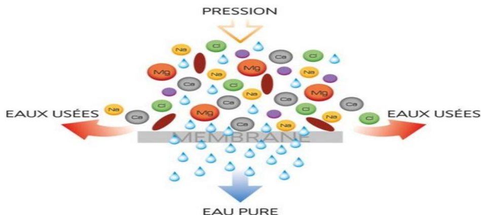
Figure 14 : Principe d'osmose inverse.
