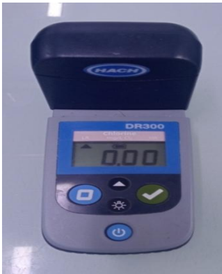
Figure 57 : Mesure du chlore libre.
