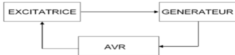
Figure I.11 : Le rôle de l'AVR.
