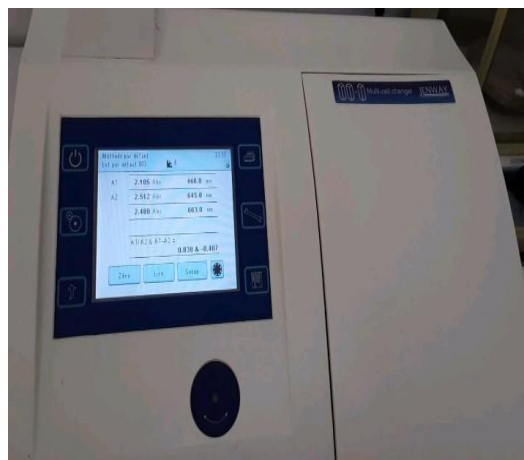
Figure 06. Spectrophotomètre pour les observations de la longueur d'onde (Originale 2023).
