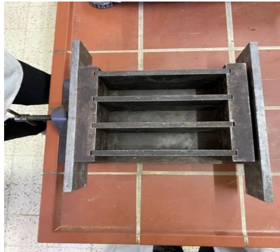
Figure IV.13 : Moule utilisé pour la fabrication des BTC
