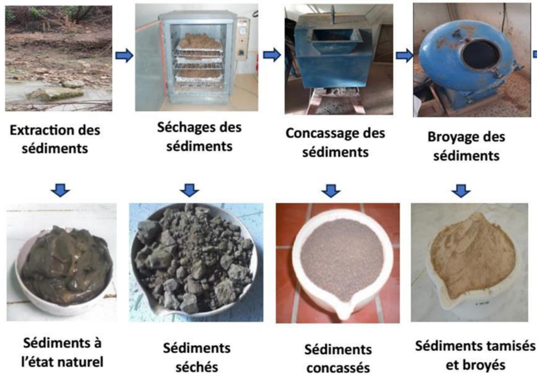
Figure IV. 2: Les étapes de traitement des sédiments de dragage [71].
