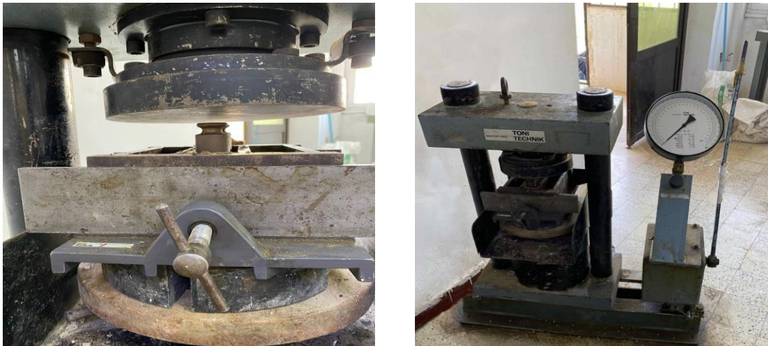
Figure IV.14 : Essais de compactage des BTC
