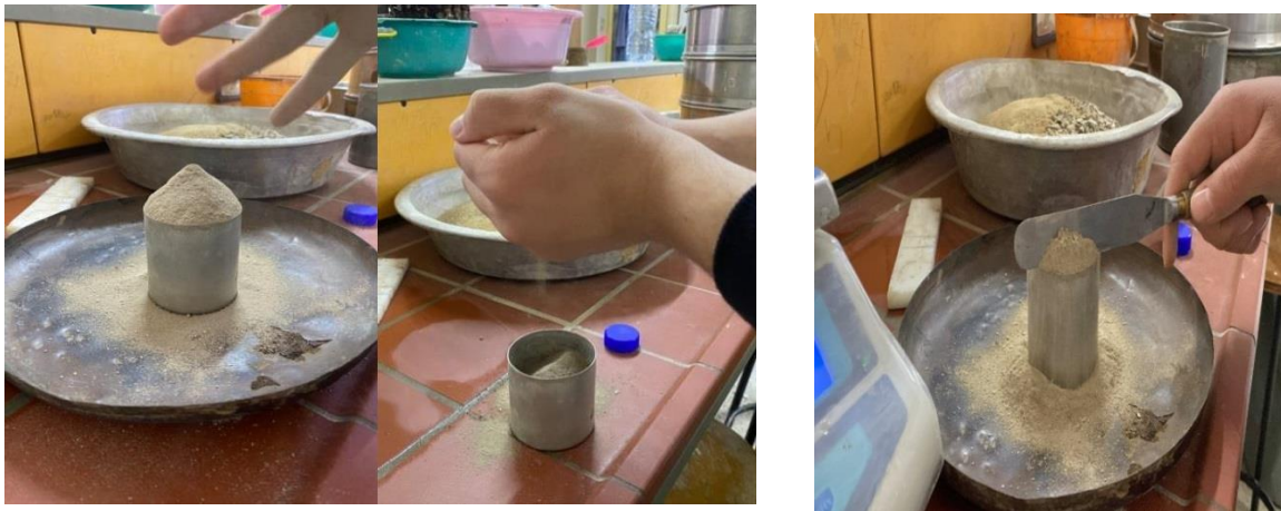
Figure IV.7 : Mesure de la masse volumique apparente de l'argile.
