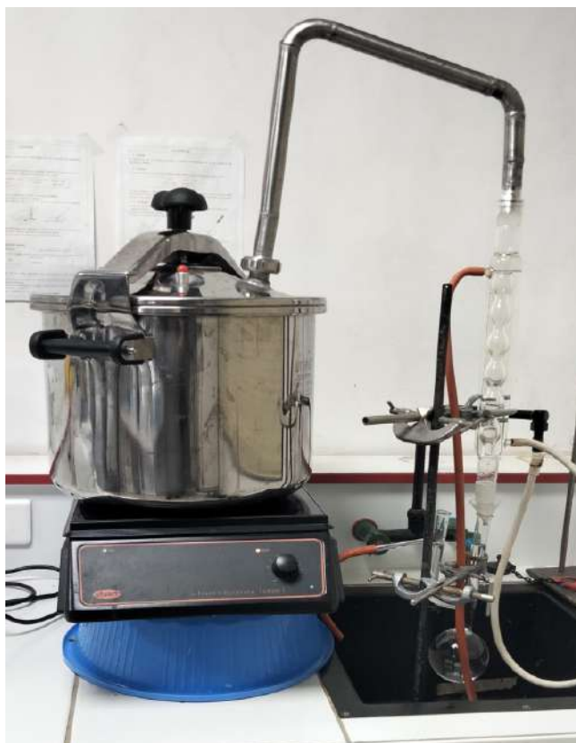
Figure 16. Dispositif d'extraction des HEs de Laurus nobilis L. par entraînement a la vapeur d'eau.
