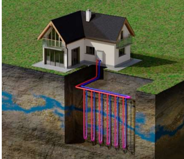
Figure17 : Une pompe à chaleur géothermique (Source : Bing).
