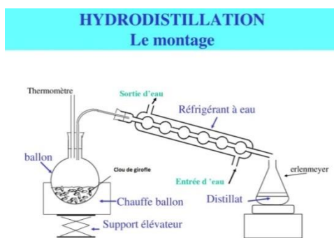
Figure 7: montage expérimental de l'hydrodistillation pour l'extraction des huiles essentielles ( Chemat, 2014 ).
