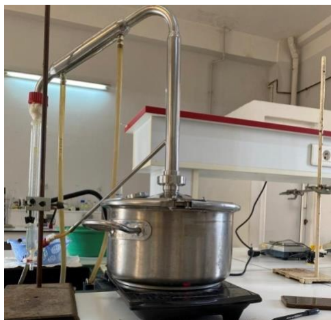
Figure 12 : appareil de distillation a la vapeur ( photo Originale,2026)
