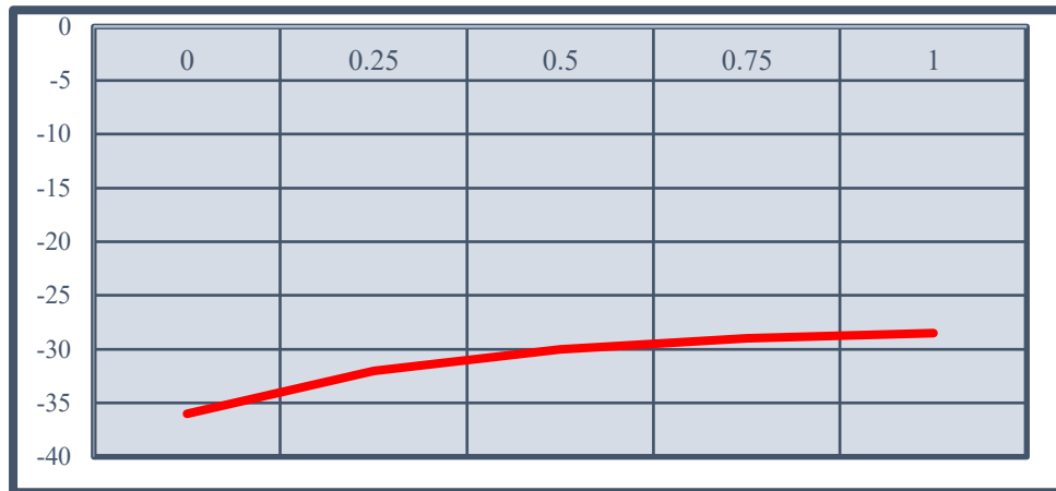
Figure III.5. Effet de la contamination de la boucle propane sur la température de sortie du GN en fonction du % des légers dans le propane.
