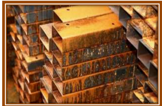
Figure 9:corrosion du métal
