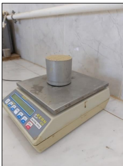
Figure IV.6. Mesure de la masse volumique apparente de l'argile.
