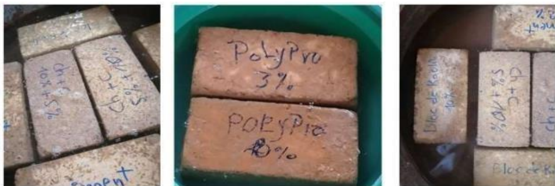
Figure III.10. Essai de tenue à l'eau des échantillons de BTC [55].
