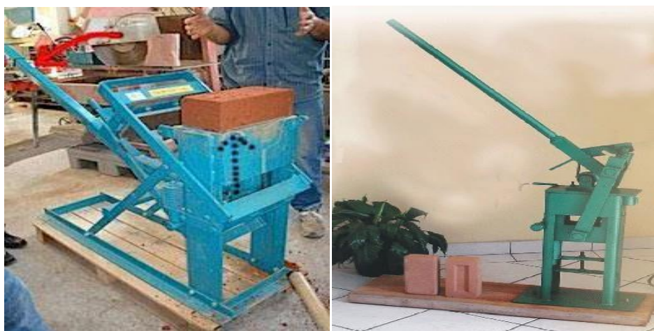
Figure II.11. Brique de terre crue comprimée réalisée à l'aide d'une presse manuelle [38].
