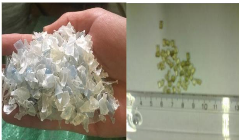
Figure I.12. PET d'une forme angulaire (à gauche) et forme de pastilles (à droite) [21].
