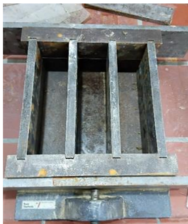
Figure IV.17. Moule métallique utilisé pour la confection des briques.
