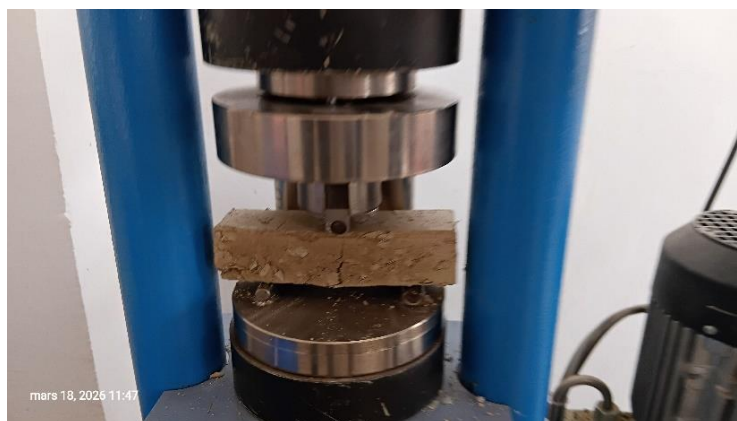
Figure V.3. Représente l'influence de l'ajout du déchet en plastique sur la résistance à la traction des BTC.
