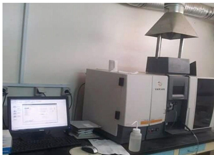
Figure 24 : Spectrophotomètre à Absorption Atomique à flamme A.ANALYSTE 100 de marque VARIAN.
