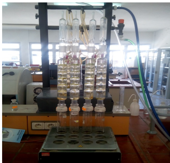
Figure 22 : Appareil de la minéralisation de type Velp muni de réfrigérants
