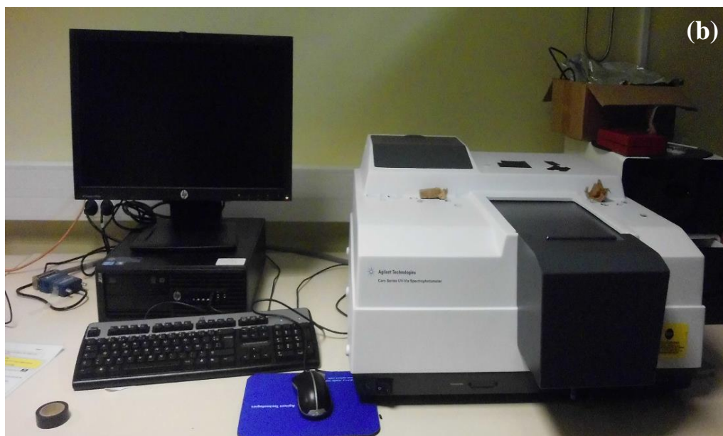
Figure II.16. : Schéma de principe d'un spectrophotomètre à double faisceau (a), spectrophotomètre Carry 200(b).
