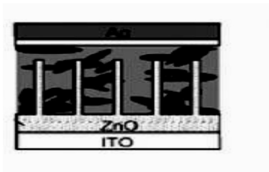
Figure I.19: La structure de cellule photovoltaïque organique hybride [56].
