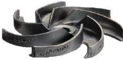
Figure(II.3) : Corrosion-cavitation d'une aube de pompe [19].
