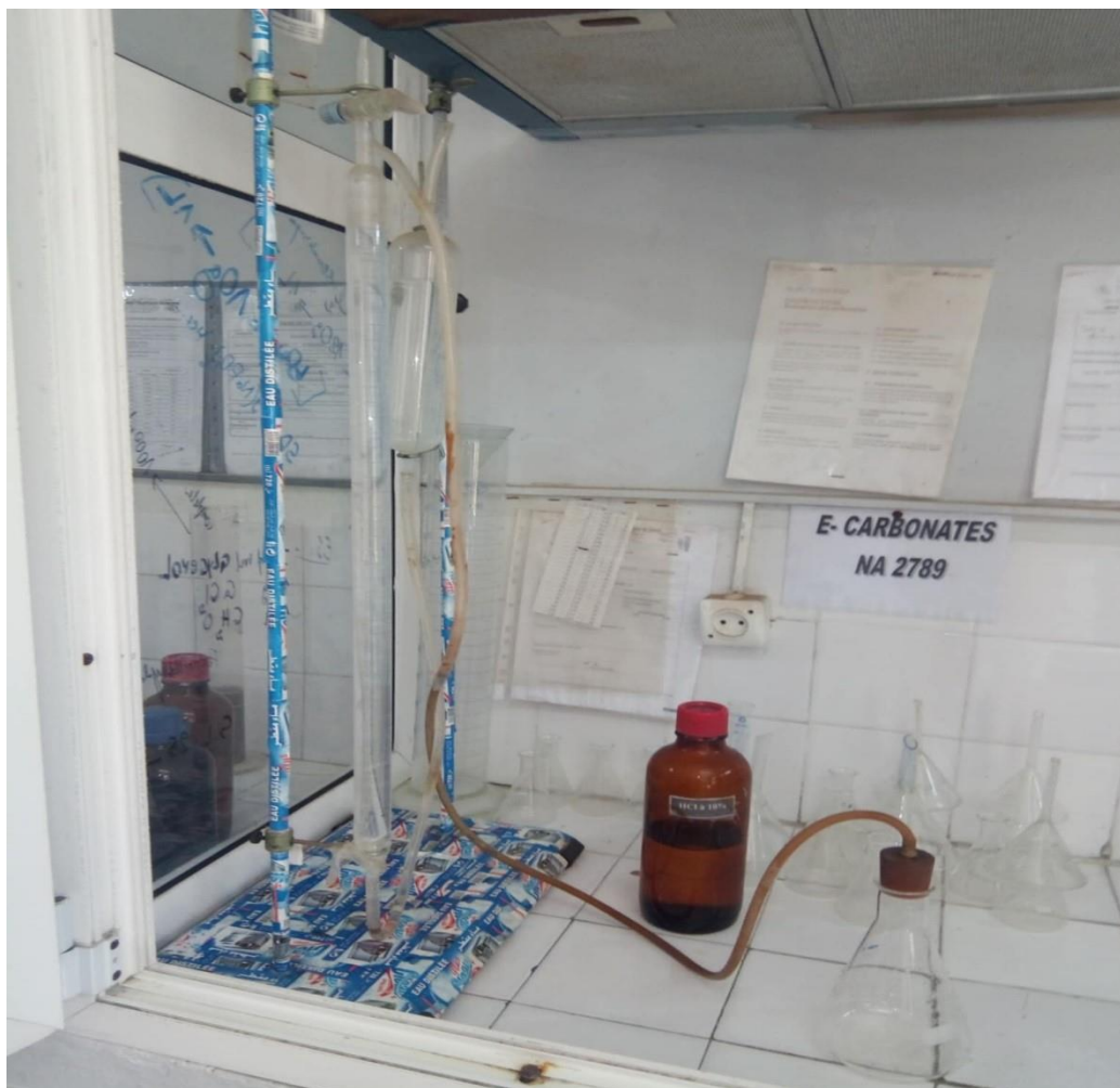
Figure IV.17 : La détermination de la teneur en carbonate a l'aide d'un calcimètre
