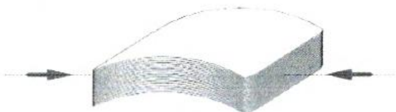
Figure 4 : La déformation d'un jeu de carte sous contraintes de compression
