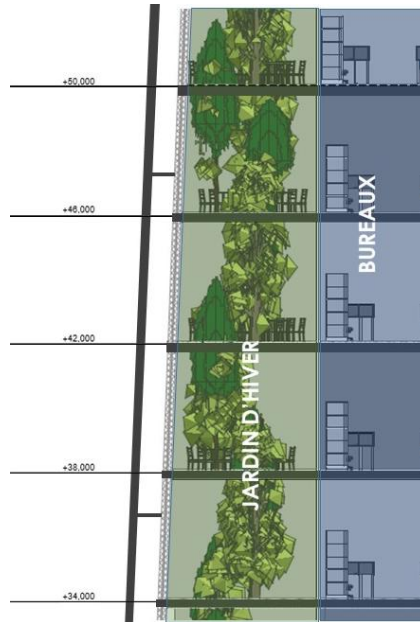
Figure 132: détail de la façade en mur rideau avec ses jardins d'hiver Source : auteurs.
