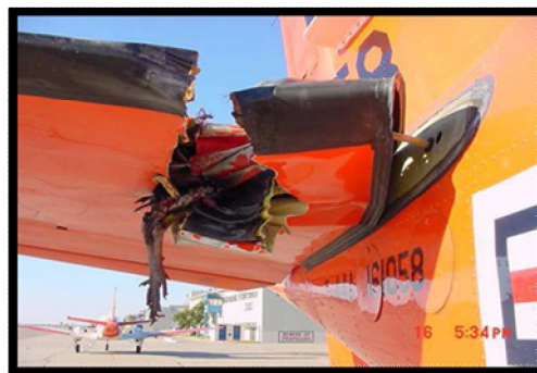
Figure (III.1): Détérioration d'une dérive suite à collision avec un oiseau [14]
