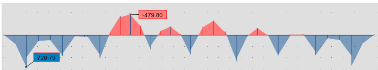
Fig VIII 23 : Diagramme des moments de la nervure plus sollicité à L'ELU sens X-X
