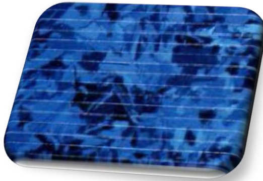
Figure 1.15 - Cellule au Silicium Polycristallin.
