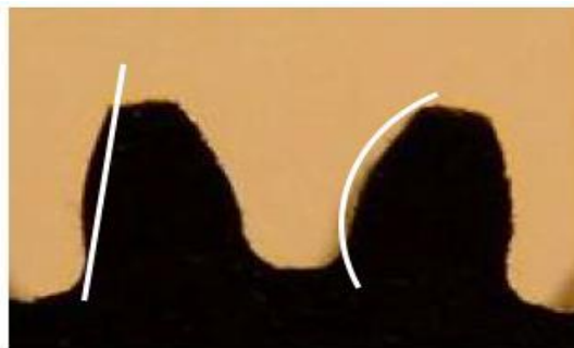
Figure II.14 Profil d'une dent en comparaison avec une droite et un arc de cercle [5]
