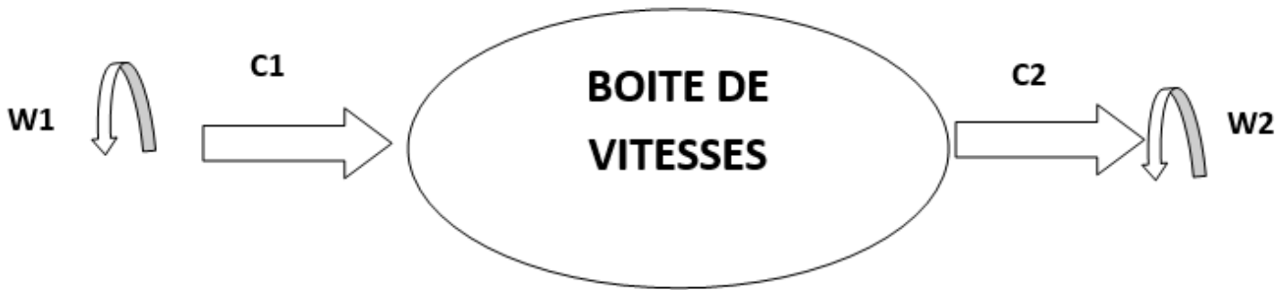
Figure III.10 : Transmission du couple et vitesse de rotation. [11]
