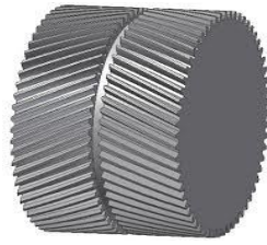
Figure II.6 Pignon à denture en chevron avec rainure centrale.
